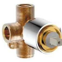
D999CP-ENG Внутреннее тело (1-функц) * Материал: латунь * Картридж: Kerox 35mm ceramic cartridge PB865104CP, PB856101CP, PB839103CP.
