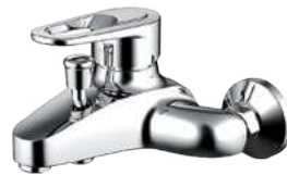
LOOP F6124182CP-01-RUS Смеситель для ванны короткий излив * Корпус - латунь * Ручка - цинк * Ceramic cartridge Sedal 40mm * Knob switch Neorel * Aerator Neorel * Coating: Chrome * Flow rate: 20L/min @ 0.3 MPa; Shower: 12L/min @ 0.3 MPa
