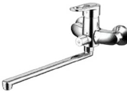
LOOP F6124182CP-02L-RUS Смеситель для ванны длинный излив * Корпус - латунь * Ручка - цинк * Ceramic cartridge Sedal 40mm * Ceramic switch Neorel * Aerator Neorel * Spout 300mm * Coating: Chrome * Flow rate: 15L/min @ 0.3 MPa; Shower: 8L/min @ 0.3 MPa
