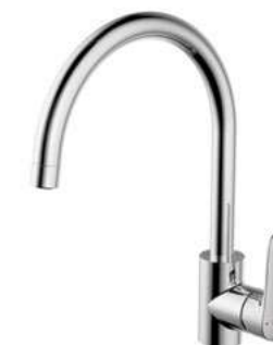
SOURCE F7173218CP-ENG Смеситель для кухни * Корпус — латунь * Ручка — цинк * Керамический картридж Kerox 35mm * Гибкая подводка 650mm M10-G1/2 SS 2шт * Аэратор Neoperl * Покрытие: Хром * Поток воды: 7.5L/min @ 0.1 MPa
