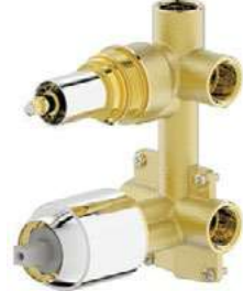
D982CP-B-ENG Внутреннее тело (2-функц) * Материал: латунь * Картридж: Kerox 35mm ceramic cartridge
